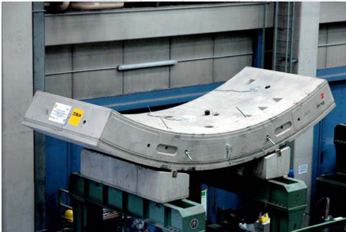
Prüfung eines Tübbings unter Temperaturlast
