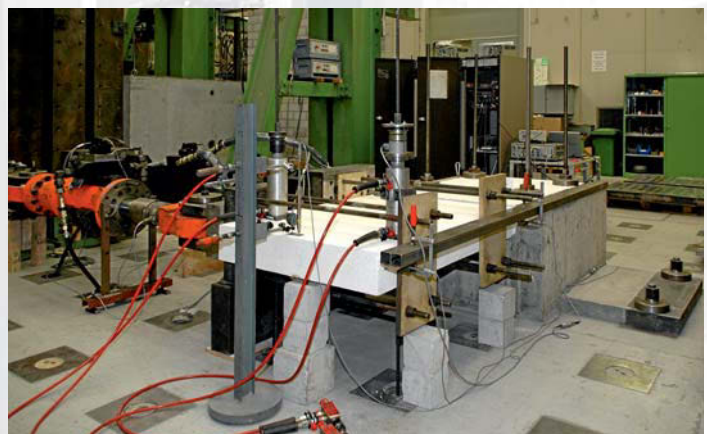
Prüfung an einer Kragplatte
