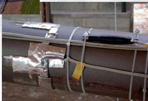
Applizierte und abgedeckte Dehnungsmessstreifen mit Kompensationsmessstelle
